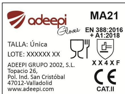
La referencia “**MA21**” es un manguito destinado a la protección frente al corte (“F”), confeccionado mediante fibra de polietileno de alto rendimiento (HPPE) e hilo tungsteno. Galga 21.
